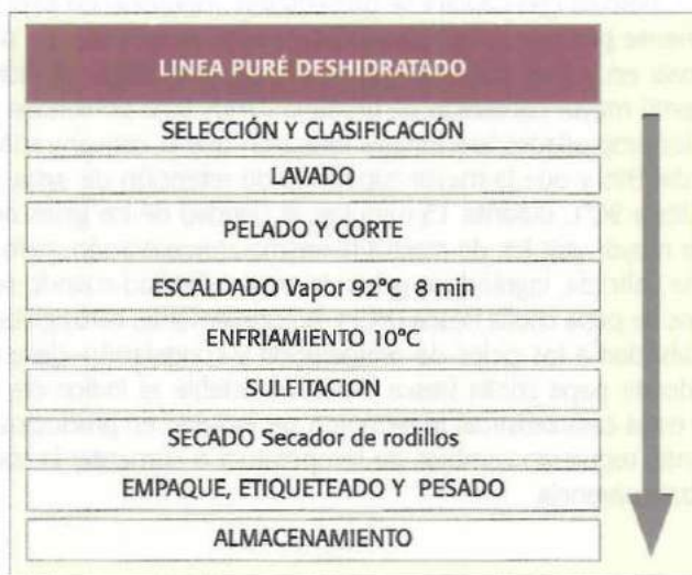
Figura No. 6. Diagrama de flujo del proceso para elaboración de puré de papa
