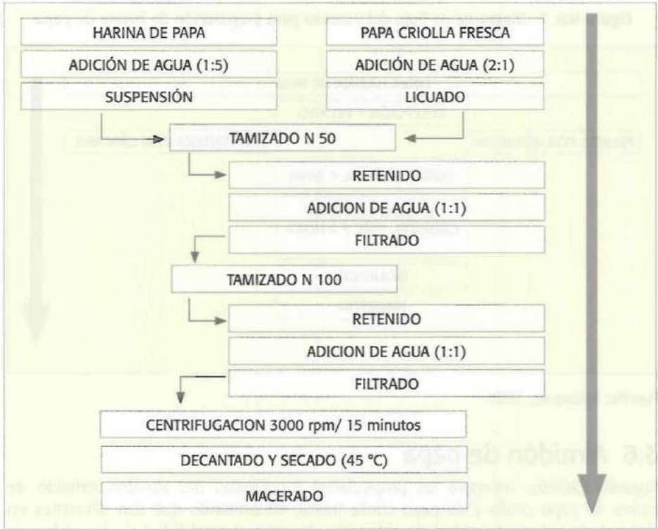
Figura No. 8. Diagrama de flujo del proceso para la obtención de almidón a partir de papa criolla.
